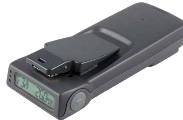
Мультифункциональное оборудование с внешними блоками детектирования позволяет провести детальное исследование образцов почв различных горизонтов почвенного профиля. Нейтронные дозиметры применяются для контроля облучения персонала при работе с генераторами нейтронов
